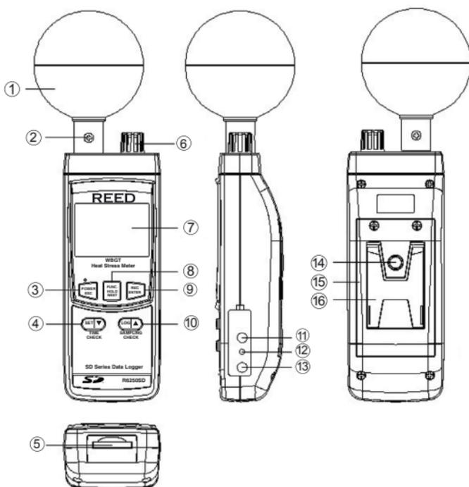
1. Capteur de température de la boule noire
