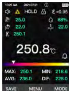
**Remarque:** Pour prendre une mesure, établissez un contact direct avec la surface testée. S'il n'y a pas de sonde thermocouple connectée au thermomètre, l'écran ACL affichera "---.°C ou °F".
