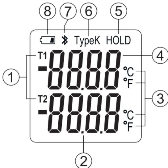
1. Indicateurs d'entrée de thermocouple T1 (voie 1) et T2 (voie 2)
